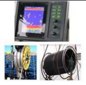
1. <u>輔助捕撈設備</u> (探魚機、絞網機及 漁船製冰機等)
