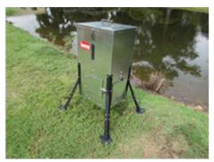
1. <u>自動投料機設備</u> 以電動方式定時為養殖魚類投餵適當 份量的飼料。
