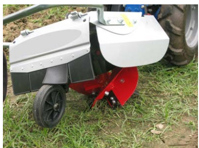
5. 旋動犁 由拖拉機驅動，用於開墾新地、 鋪設隆起的土床，以及 在堅硬土層挖掘排水坑。
