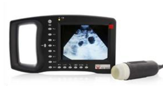
32. 豬隻測孕機 用於檢查豬隻的懷孕狀況，以加強對受孕母豬的管理和照顧，提升初生豬隻的質素。
