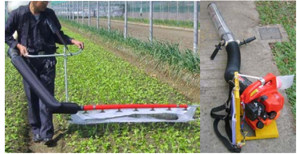
28. 捕蟲機 用於捕捉細小害蟲。
