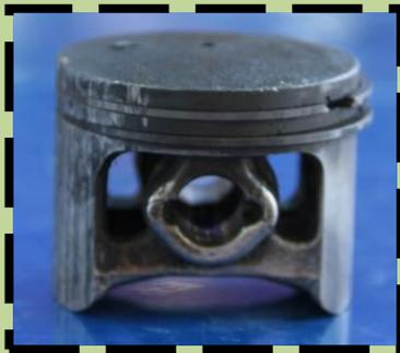
使用白電油後損壞的核心機件
