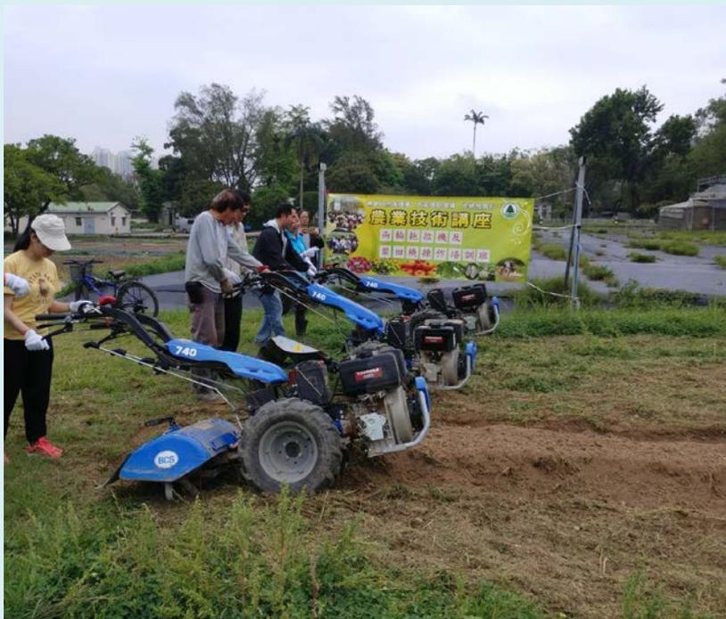
為進一步推動本港農業現代化和機械化，本署再次舉辦兩輪拖拉機及犁田機操作培訓班，讓農友在技術人員安全指導下親身體現學習操作農機。同時亦從海內外引入不同類別的新式犁田機，以供本地農友按自身的需要以嘗試操作，進一步幫助農友選擇合適的農機以提高農耕作業的工作效率和減少體力勞動。
