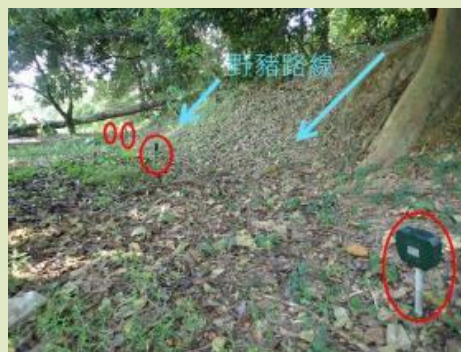
置於野豬行經路線附近 紅外線感應器探測到動物時 (有效範圍約6-8米)， 發出超聲波及LED強閃光
