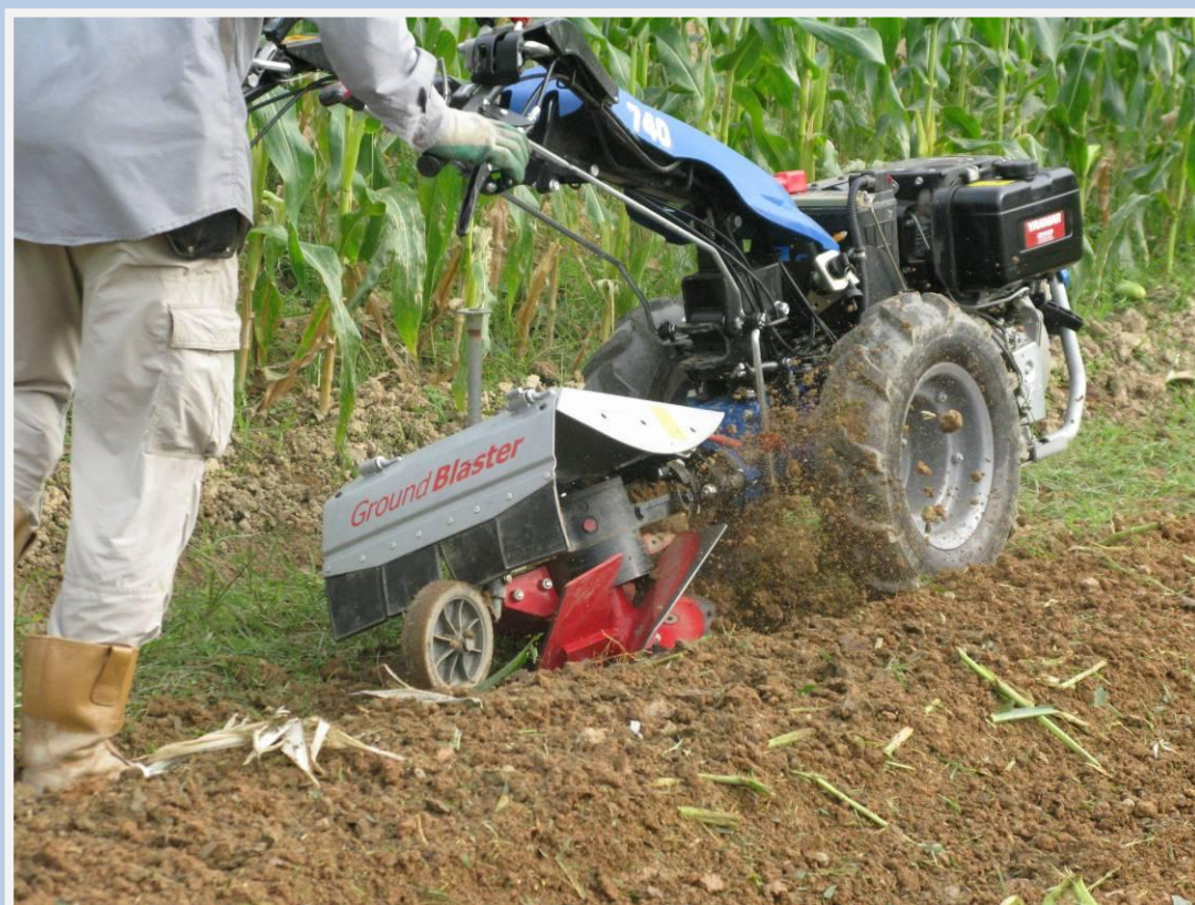
使用裝上培土部件的新式農機能大幅節省土地整畦及作物培土的時間
