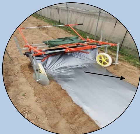
地膜鋪設器：二人同時操作的拖拉器具，比起人手鋪設節省大量時間及氣力。
