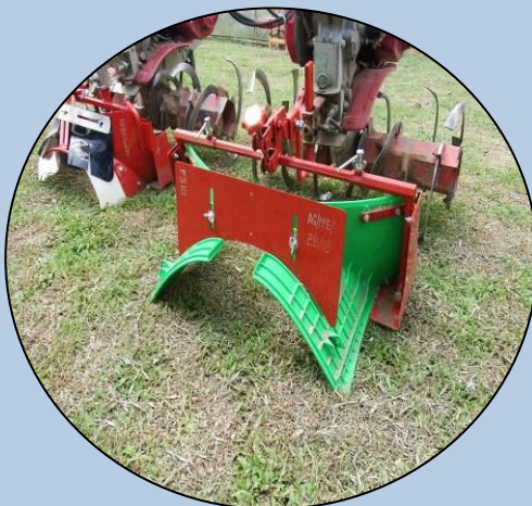
精細除草器：半密封式打草器，十分適用於清除作物之間的雜草。
