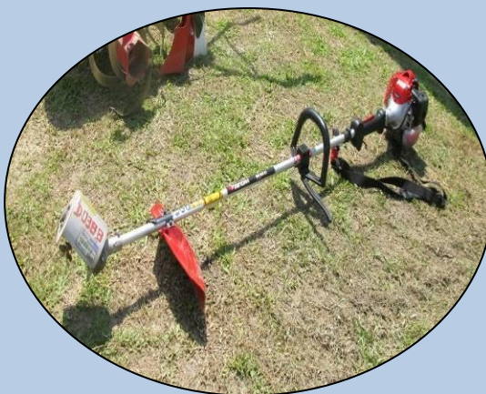
精細除草器：半密封式打草器，十分適用於清除作物之間的雜草。
