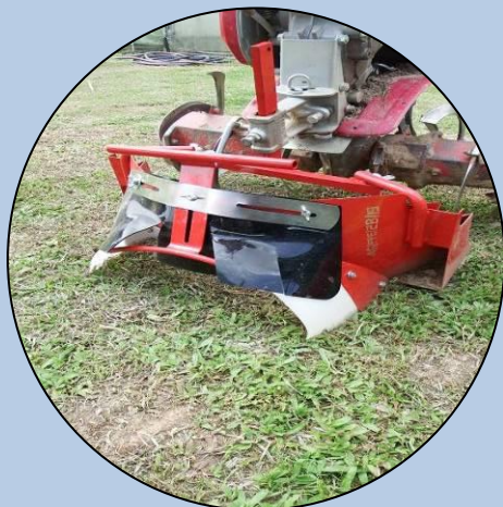
地膜鋪設器：二人同時操作的拖拉器具，比起人手鋪設節省大量時間及氣力。
