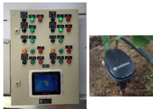
48. 農場遙距監控系統 用於遠端監察農場環境及控制各種儀器。
