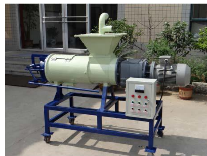
24. 固體液體廢物分離機 用於分離禽畜廢物中的固體及液體， 以提升處理效率。
