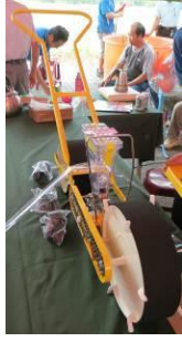
13. 種植機 用於精確地直接播種到土床上。
