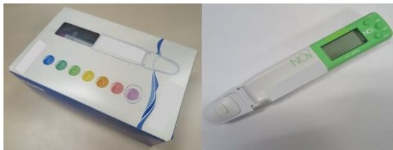
43. 硝酸鹽離子檢測儀 用於快速測量樣品中的硝酸鹽離子濃度。
