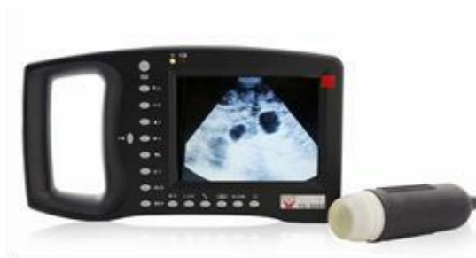
32. 豬隻測孕機 用於檢查豬隻的懷孕狀況，以加強對受孕母豬的管理和照顧，提升初生豬隻的質素。
