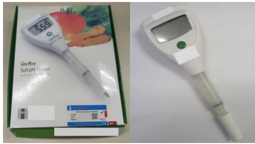
41. 土壤酸鹼度測量儀 用於快速測量土壤中的酸鹼值。
