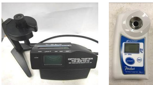
31. 電子糖度計 用於初步測試農產品的甜度，以掌握採收時機和管理農產品質量。
