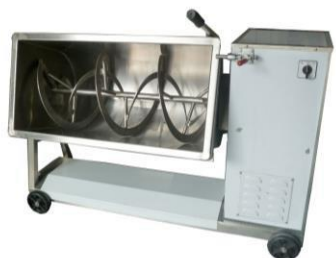
33. 混合機 用於攪拌和調配禽畜飼料，以提升禽畜養殖的質素，也可用於其他農用物資廢料，以加強農場的管理。
