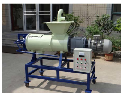
24. 固體液體廢物分離機 用於分離禽畜廢物中的固體及液體， 以提升處理效率。
