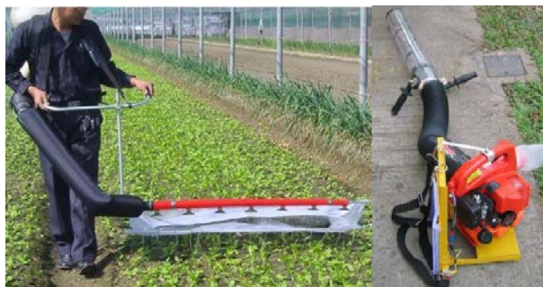
28. 捕蟲機 用於捕捉細小害蟲。
