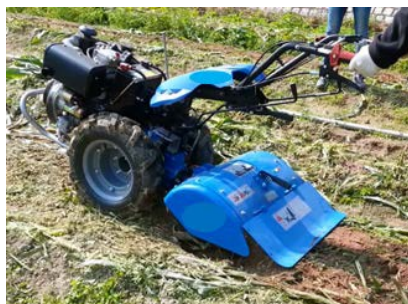
2. 拖拉機裝配的旋耕器 用於在耕作前打碎壓實的泥土。
