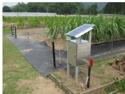
20. 電圍網 防止野生動物破壞農作物。
