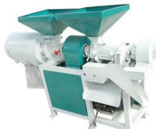
34. 飼料研磨機 將粒狀飼料(例如粟米)研磨成粉，以便調配飼料及餵飼禽畜，從而提升養殖的質素。
