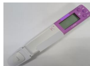
44. 鉀離子檢測儀 用於快速測量樣品中的鉀離子濃度。
