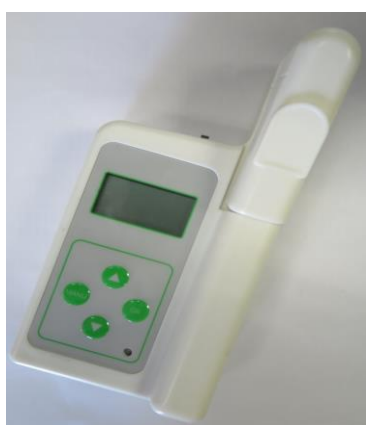
47. 葉綠素測試儀 在無損植物的情況下，用於測試植物的葉綠素含量、葉面溫度及濕度。
