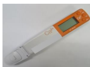
45. 鈣離子檢測儀 用於快速測量樣品中的鈣離子濃度。
