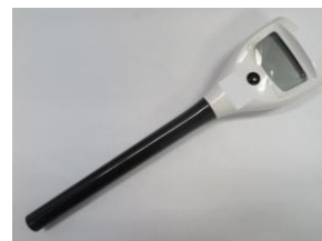
42. 土壤電導度測量儀 用於快速測量土壤中的電導率。
