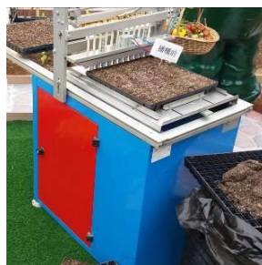
30. 苗盤播種機 用於將種子播種在苗盤上。
