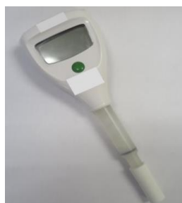
41. 土壤酸鹼度測量儀 用於快速測量土壤中的酸鹼值。
