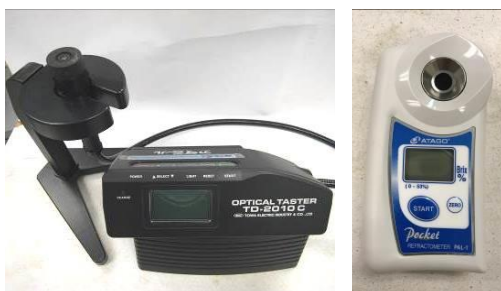
31. 電子糖度計 用於初步測試農產品的甜度，以掌握採收時機和管理農產品質量。
