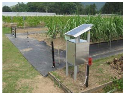
20. 電圍網 防止野生動物破壞農作物。
