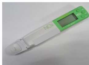
43. 硝酸鹽離子檢測儀 用於快速測量樣品中的硝酸鹽離子濃度。
