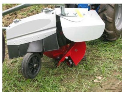
5. 旋動犁 由拖拉機驅動，用於開墾新地、 鋪設隆起的土床，以及 在堅硬土層挖掘排水坑。
