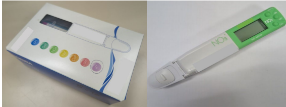
43. 硝酸鹽離子檢測儀 用於快速測量樣品中的硝酸鹽離子濃度。
