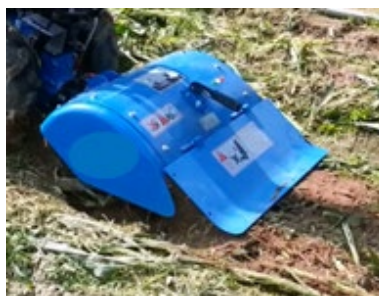
2. 旋耕器 用於在耕作前打碎壓實的泥土。
