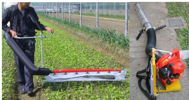
28. 捕蟲機 用於捕捉細小害蟲。
