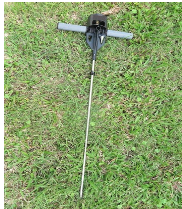
46. 土壤硬度測試儀 用於測量土壤緊實程度。
