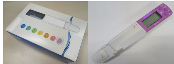
44. 鉀離子檢測儀 用於快速測量樣品中的鉀離子濃度。
