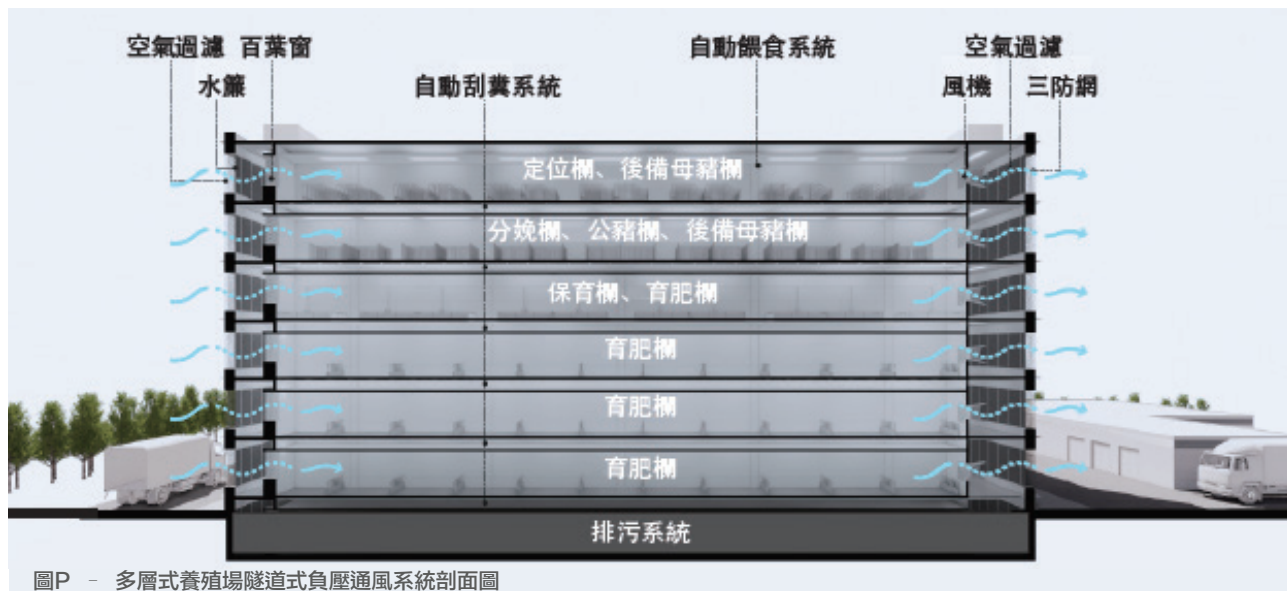
圖P - 多層式養殖場隧道式負壓通風系統剖面圖
