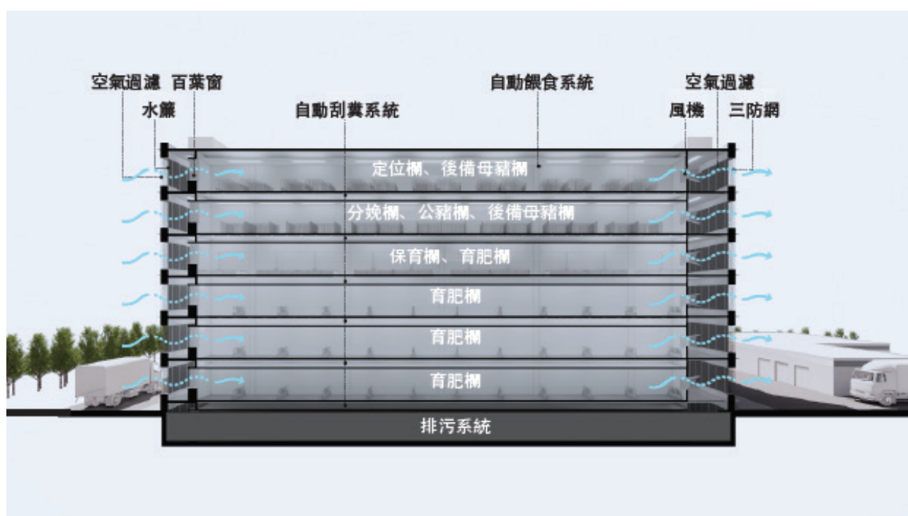
圖P - 多層式養殖場隧道式負壓通風剖面圖
