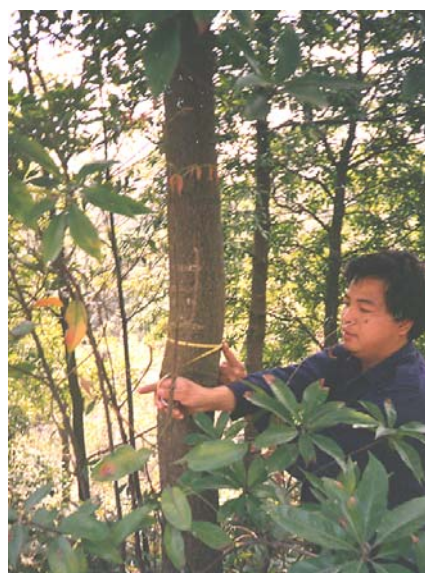
圖 3：使用直徑量尺是量度樹木胸徑的另一方法，特別適合大型樹木
