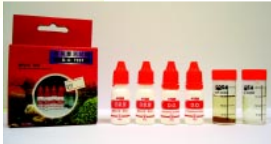
測定溶氧量的試劑：根據指示，將定量的魚塘水按次序加入藥水，待變色後與標準色版對照，可得出魚塘水的溶氧量
