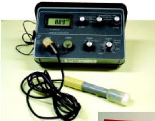
測氧機：將量度棒直接放在水中便可得出讀數。
